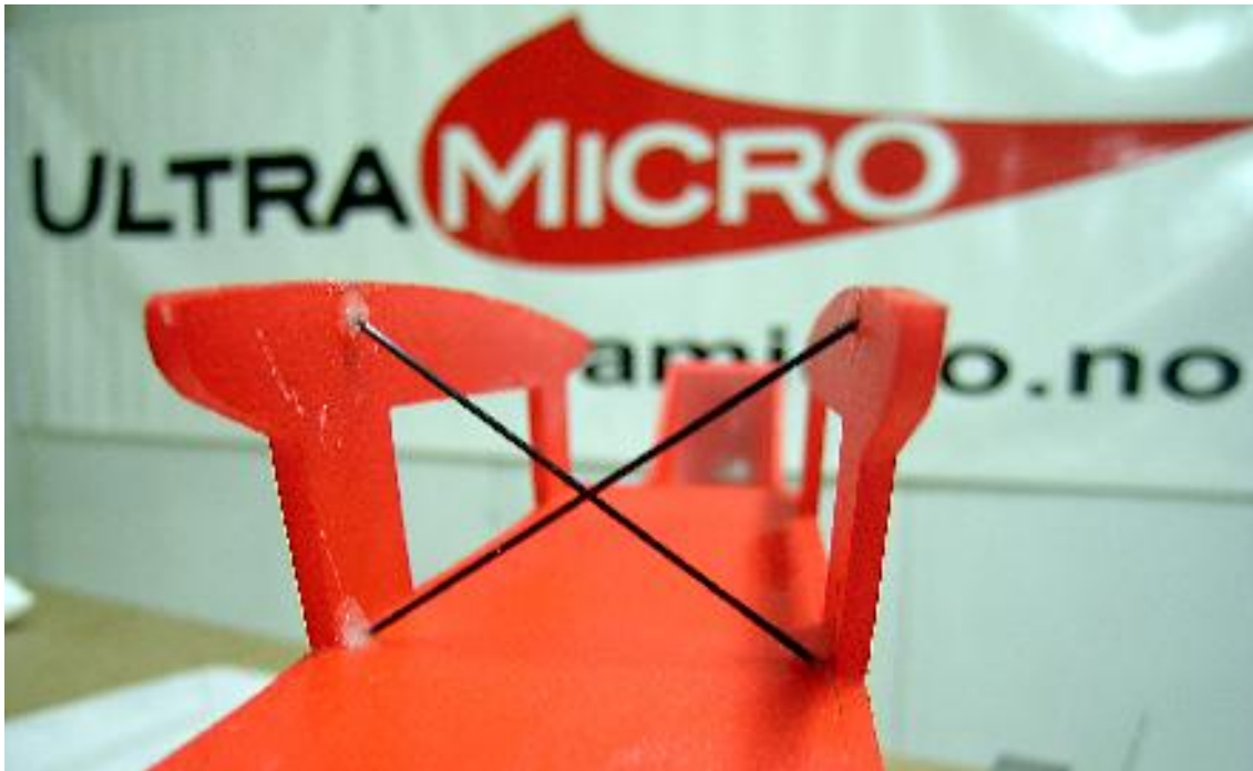
Forsterk vingestøtten til overvingen med karbontråd.
