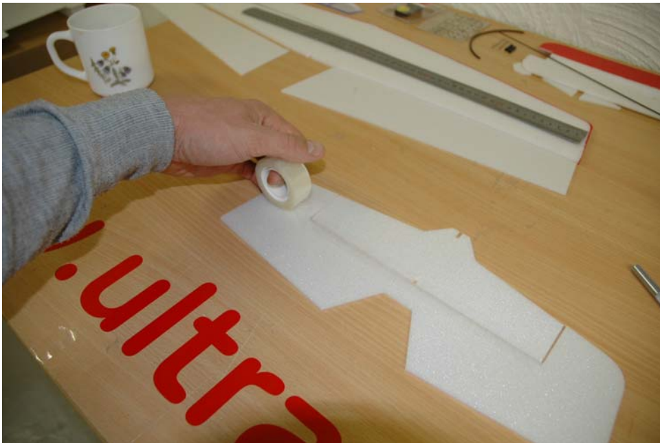
Hengse roret med klar tape. Hing rudder to horizontal stabilizer with clear tape
