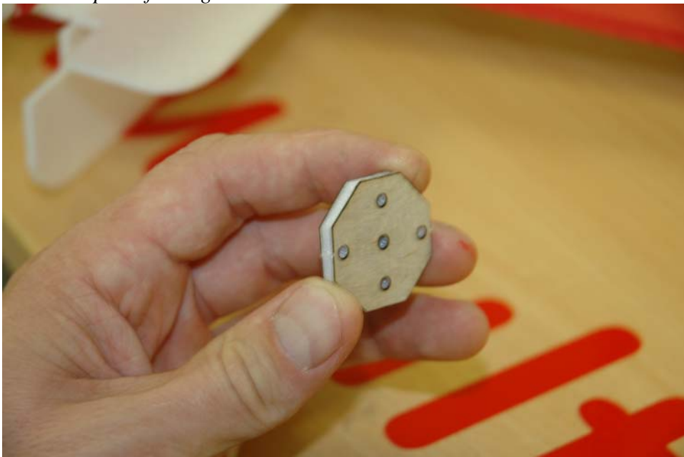
Laminer delene som utgjør motorspant. Laminate parts for engine mount.
