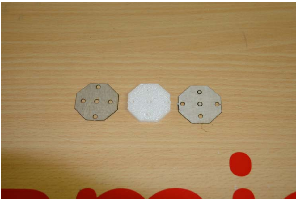
Laminer delene som utgjør motorspant. Laminate parts for engine mount.
