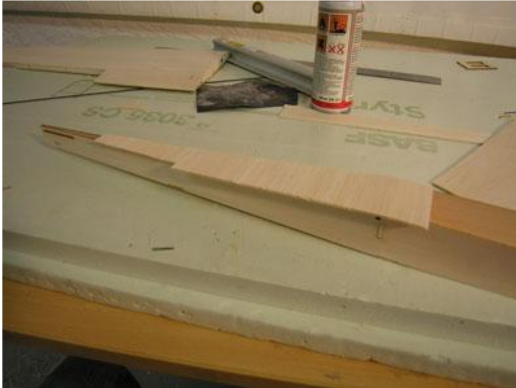
Plank kroppens overside med veden på tvers. Glue fuselage top with balsa grain across fuselage.
