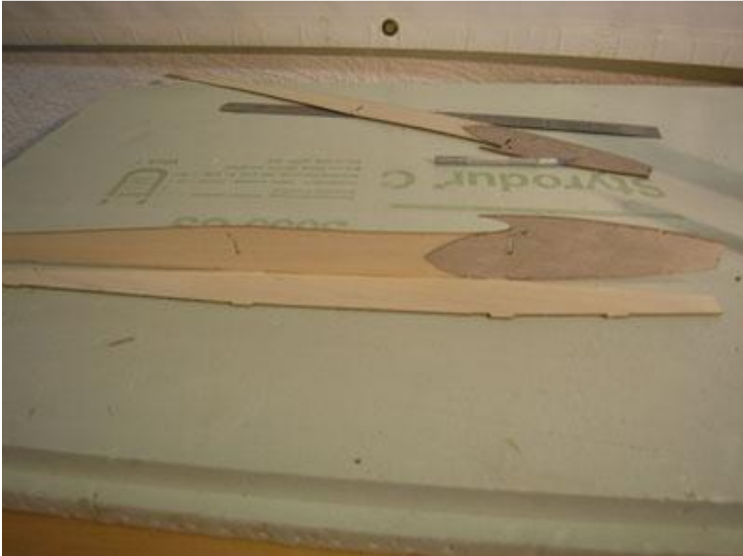
Lim bunn til den ene kroppssiden. Lim kun senterstykket foreløpig. Glue center part of fuselagebottom to fuselag half.
