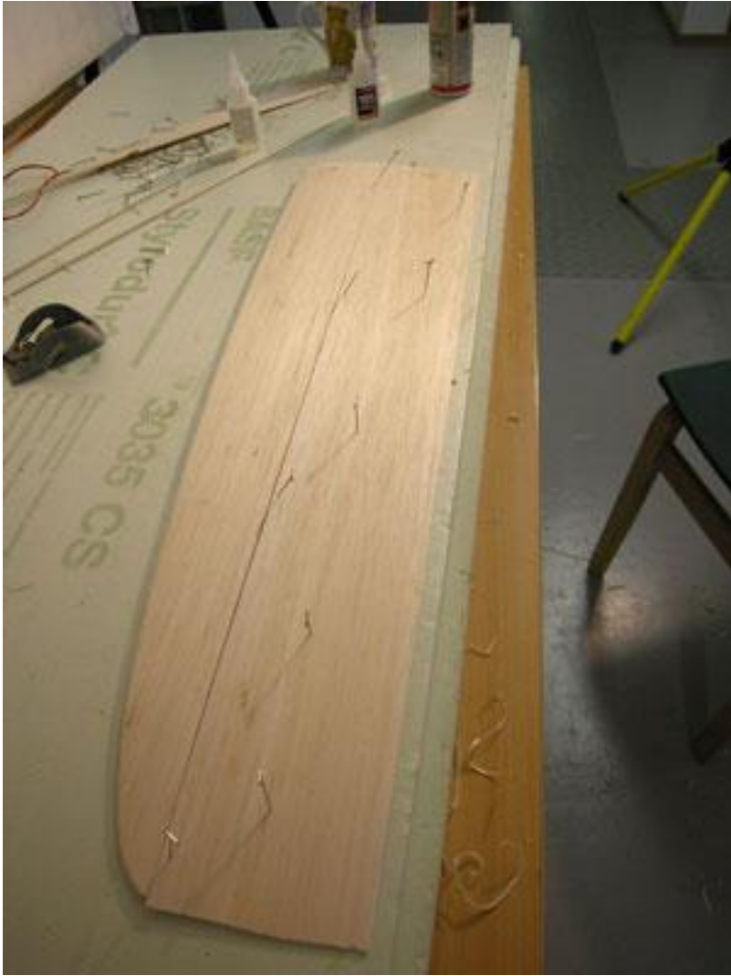
Plank bakre del av vingens overside. Glue rear top skin into position!
