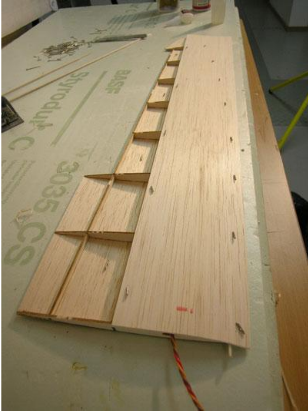
Plank vingens overside, fremre del først. Glue balsa top skin into position.
