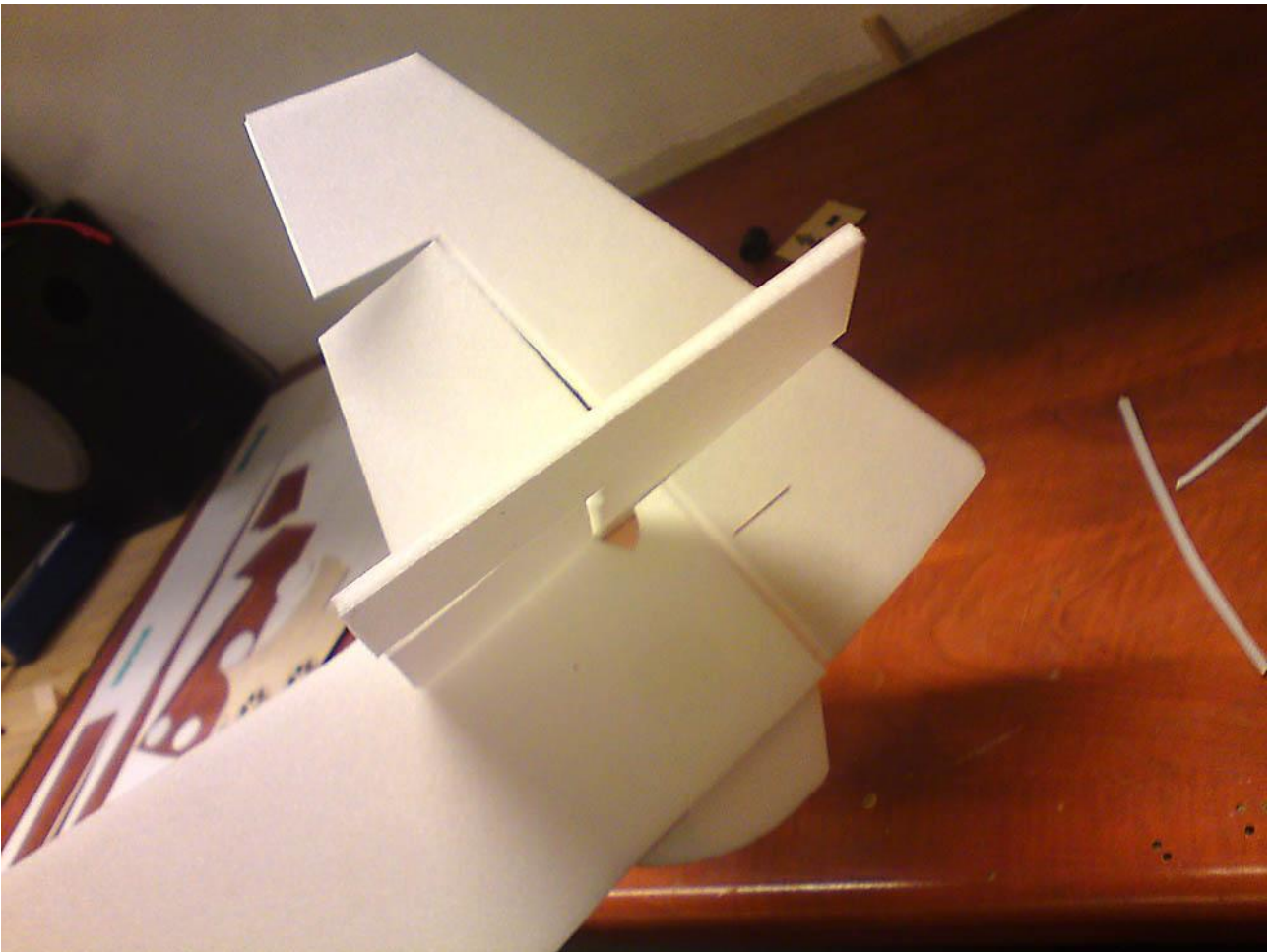
Skråskjær sideroret og hengsle på plass.
